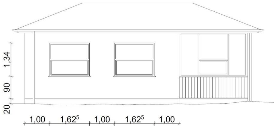
Ansicht Nord - zwei Vertikalschiebefenster \_ Fensterbreite 1,62<sup>5</sup> m
